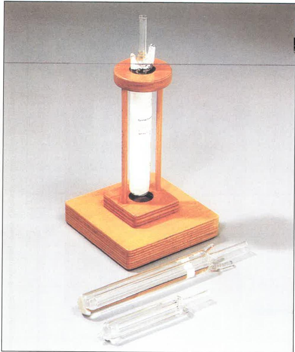
Ћелија за остваривање температуре тројне тачке воде ( $0,01^{\circ}\text{C}$ ) је најбитнија дефинициона фиксна тачка Међународне температурне скале (ITS-90). Служи за дефинисање келвина, јединице термодинамичке температуре.
